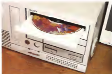
Il drive per i CD-ROM è del tipo «caddy» più veloce di impiego. Ma non pensate di installare l'unità centrale in posizione verticale.
